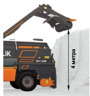
Высота подъема фрезы до 4 метров
