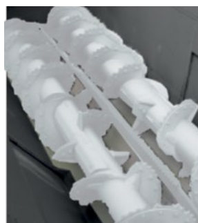
Дно бункера из нержавеющей стали толщиной 8 мм
