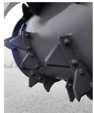
Загрузочный фрезерный барабан модели MV 140 M
