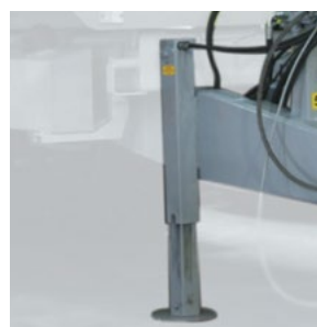
Гидравлическая опора дышла для удобной парковки
