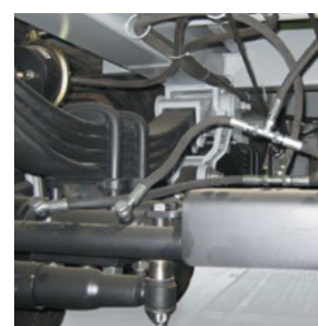
Стабилизация кузова при разгрузке
