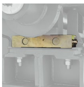
Весовая система для контроля перегруза
