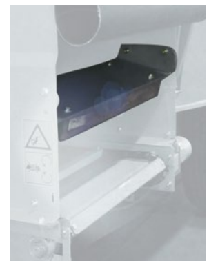
Магнитный улавливатель металлических предметов
