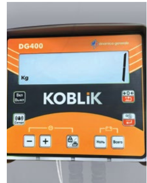
Весовой индикатор модели DG 400 на всех кормораздатчиках серии MV
