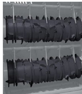
Измельчающий фрезерный барабан оснащен брусом с ножами
