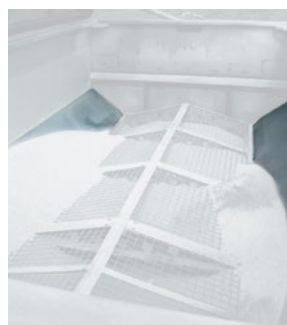
Бункер из нержавеющей стали 8 м 3
