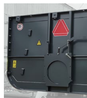
Гидравлический задний борт с автоматической блокировкой и выгрузное окно в заднем борту для установки шнека-перегрузчика
