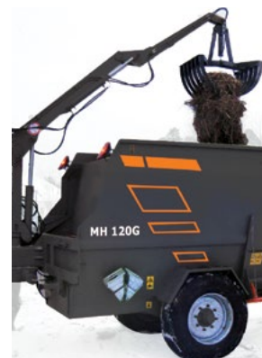
Угол поворота грейфера -240° без доворота машины
