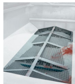
Решетка из нержавеющей стали внутри бункера (защита продукта от сора и обеспечение равномерности засыпки)
