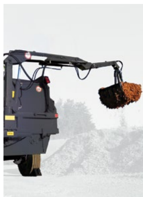
Удобная механизированная погрузка до 300 кг
